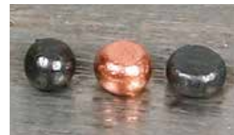
Blei (r.) deformiert beim Aufprall, Kupfer (m.) etwas und Weicheisen (l.) so gut wie gar nicht.
