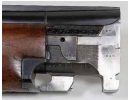
Die Chokeangaben muss man genau prüfen, hier ¼ und ¾ – damit wäre der obere Lauf für harte Blei-Alternativen zu eng gebohrt.
