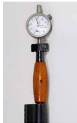
Finden sich keine Angaben zur Laufverengung, muss man nachmessen.
