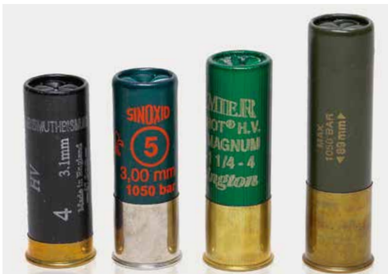
Beim Einsatz von Nichtbleischrot im Jagdbetrieb spielt die Länge des Patronenlagers (= max. Hülsenlänge) eine entscheidende Rolle (v. l.): 67,5, 70, 76 und 89mm.
