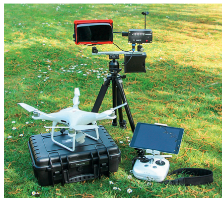
Kategorie 1 Drohne DJI Phantom 4 mit Flir-Boson-Wärmebildkamera und zusätzlicher Empfangseinheit.
